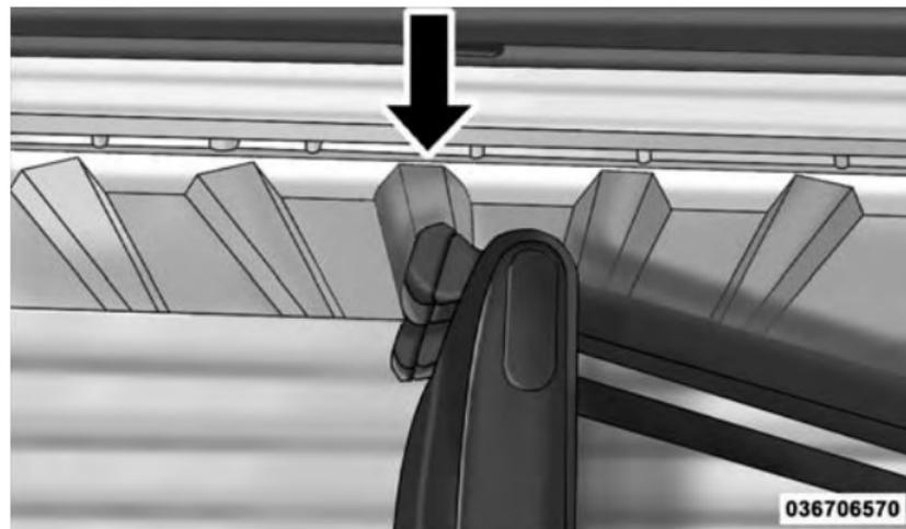
**Aligning Gate To Slots**
